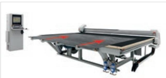
Les pieds escamotables se remettent automatiquement en position de sécurité pour le début de la coupe. La tête d'usinage commence automatiquement le cycle de coupe.
