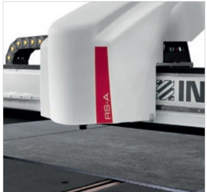
La tête d'usinage est dotée d'un système automatique de gestion de la pression de coupe qui permet de doser de manière correcte la force exercée par la roulette du début jusqu'à la fin de la coupe. La gestion de la vitesse des axes et les composants électroniques et mécaniques de grande qualité permettent d'optimiser les temps de façonnage, en garantissant flexibilité et dynamisme.
